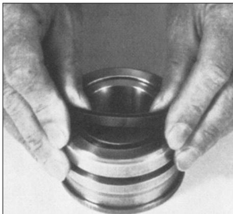
Ilust. 4.28 Montagem por deformação do anel afilador
