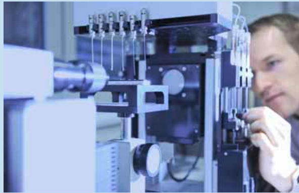
Um medidor de alta velocidade do ângulo de contato é usado para determinar a molhabilidade.
