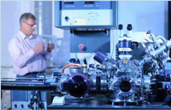
A composição química da superfície é descoberta usando espectroscopia fotoelétrica de raio-X.
